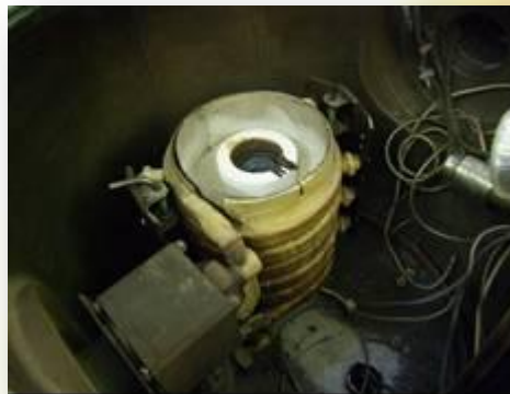
Innenansicht: der Tiegel befindet sich umhüllt von Trockenvibrationsmasse in der Spule (gelb)
